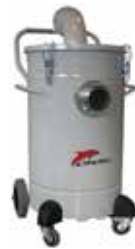
۲۱ - مخزن رابط برای جمع‌آوری مواد بسیار داغ یا حتی گداخته این مخزن با آب پر می‌شود تا در زمان جمع‌آوری مواد گداخته یا بسیار داغ، آنها ابتدا وارد آب شوند و سپس گرد و غبار ناشی از آنها به همراه هوا از مخزن خارج و به سمت جارو حرکت می‌کنند.
